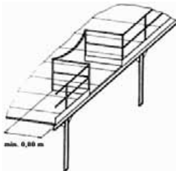
Abb. 11: Beispiel eines eingezogenen Abstellplatzes
